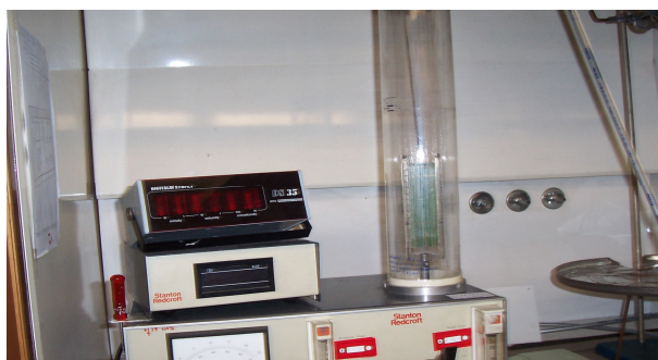
Obr.2.: Celkový pohľad na meraciu aparatúru „Oxygen Index“ [21]
