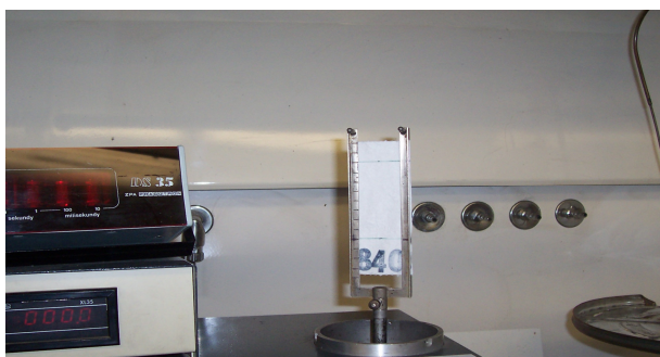
Obr.4.: Skúšobné zariadenie so vzorkou D pred meraním [21]
