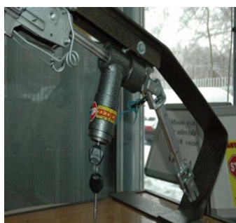
Obrázok 2.2 Mechanické zabezpečenie na tyči riadenia ZEDER [7]
