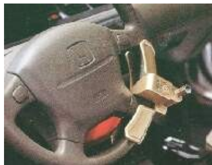
Obrázok 2.1 Mechanické zabezpečenie volantu [1]
