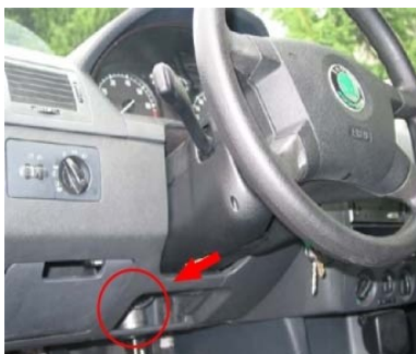
Obrázok 2.2 Mechanické zabezpečenie na tyči riadenia ZEDER [7]
