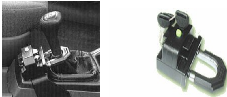
Obrázok 2.3 Uzamknutie riadiacej páky vonkajším zámkom detail zámky [2]
