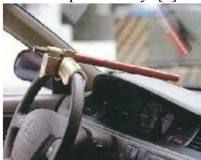
Obrázok 2.1 Mechanické zabezpečenie volantu [1]
