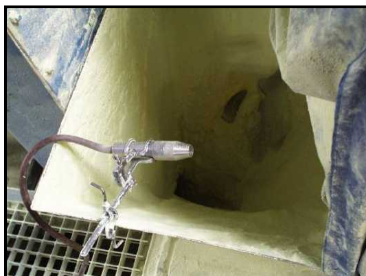
Obrázek 2 Detail sondy - měření prašnosti při vykládce síry
