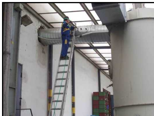
Obrázek 6 Izokinetický odběr vzorků z potrubí
