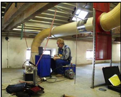
Obrázek 5 Izokinetický odběr vzorků z potrubí
