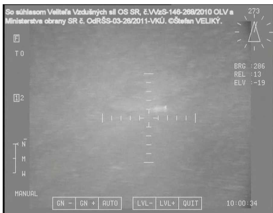
Obrázok 8 Detekcia osoby na vodnej hladine cez OE prostriedok vrtuľníka Mi-17 LPZS MO SR. [Zdroj: autor]
