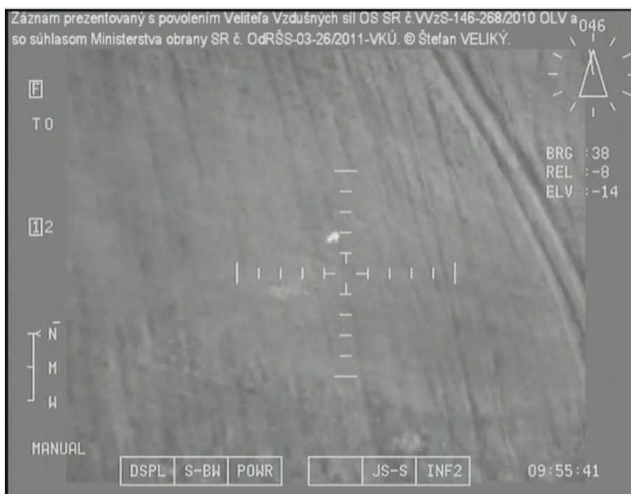
Obrázok 6 Detekcia osoby v leže, v trávnom poraste cez OE prostriedok vrtníka Mi-17 LPZS MO SR. [Zdroj: autor]
