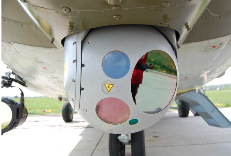
Obrázok 5 Optoelektronický prostriedok vrtuľníka Mi-17 LPZS MO SR [Zdroj: autor]
