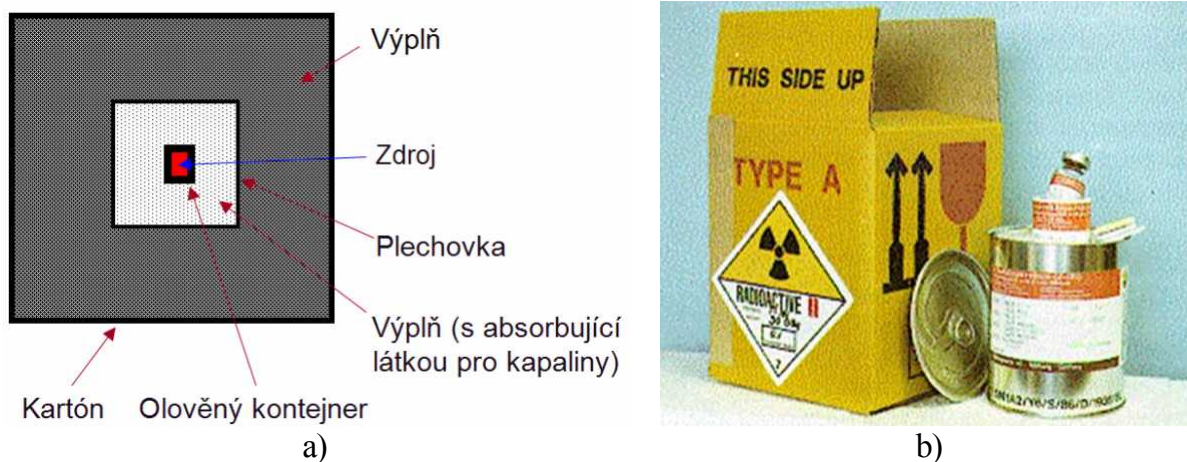
Obrázek 2 Balení radiofarmaceutické látky pro přepravu, a) vnitřek obalu se zářičem a jeho stíněním, b) pohled na přepravní kontejner a vnější obal z kartonu.
