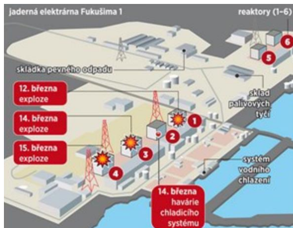
Obr. 1. Jaderný komplex po zemětřesení a následné havárii, která byla vyvolána nadměrně vysokými vlnami tsunami (podle [1]).
