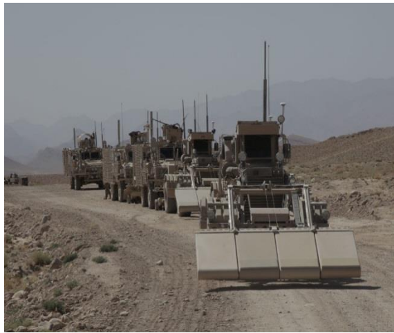
Obrázok 3. Rušičky signálu „Jammers“ a „Husky Mounted Detection System“ zdroj: autor a http://c-s-i.com/vehicles/hmds
