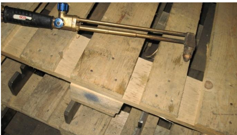
Obrázok 8 Rezací nastavec RN-7 s kolieskom pre rezanie plynom [Zdroj: vlastná dokumentácia]
