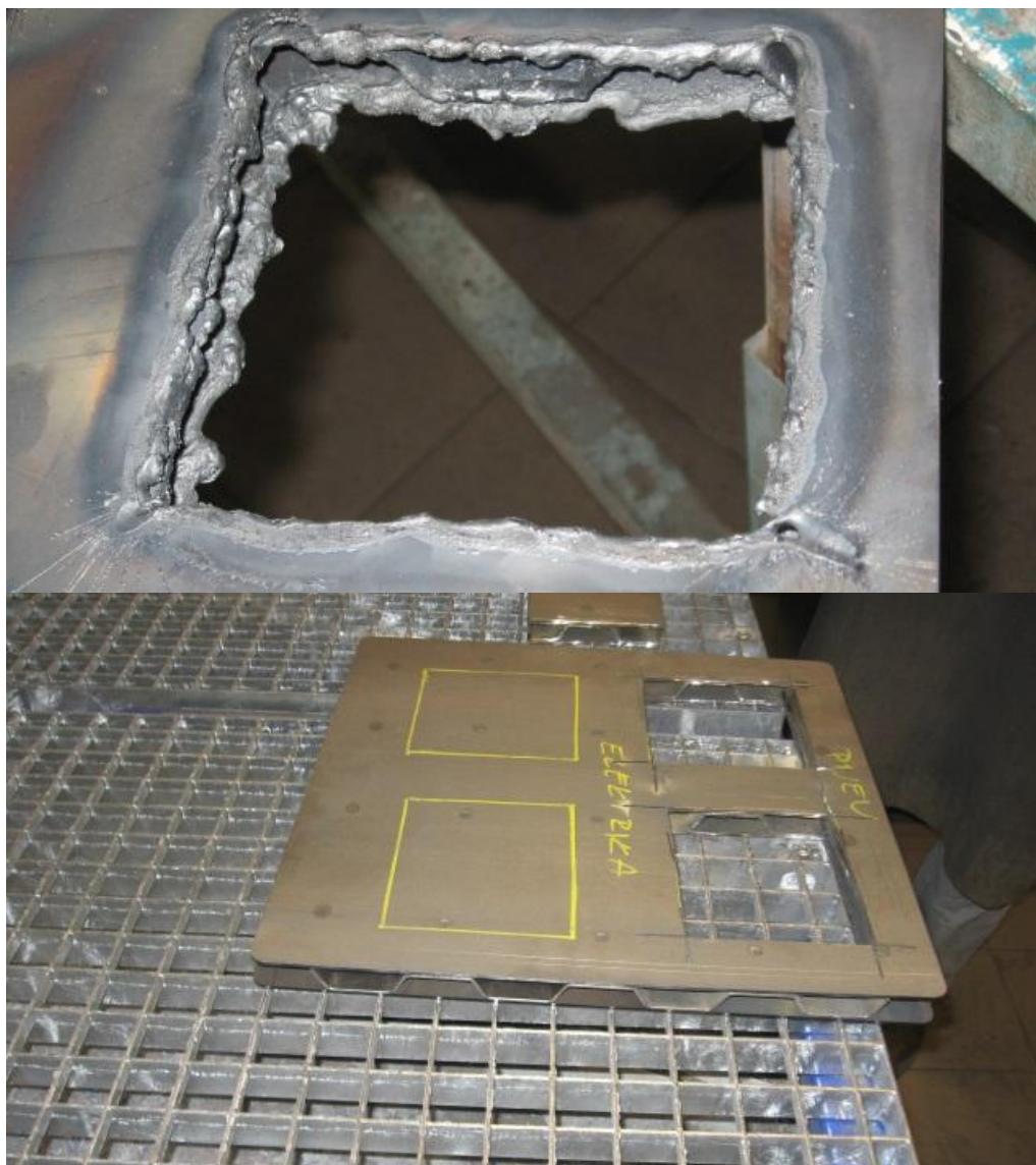
Obrázok 9 Výsledky reálnych skúšok (Zdroj: rezanie plynom a použitie uhlovej brúsky) [vlastná dokumentácia]
