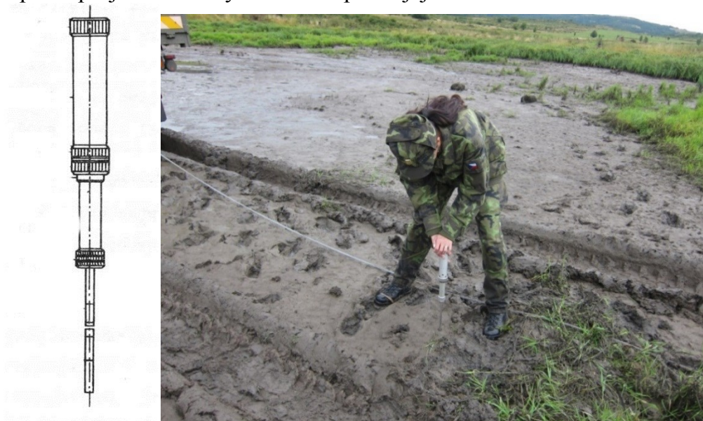
Obrázek 3 Teleskopický penetrometr [2]. Měření teleskopickým penetrometrem.
