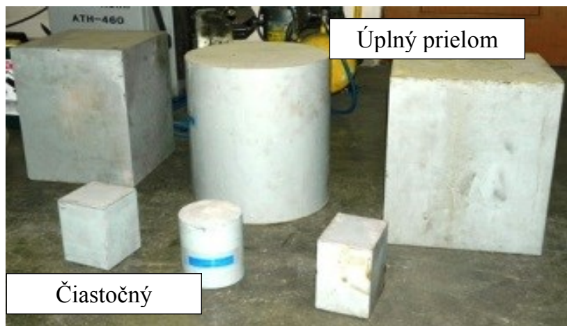
Obrázok 1 Skúšobné telesá pre úplný i čiastočný prielom ( Zdroj: vlastná dokumentácia )
