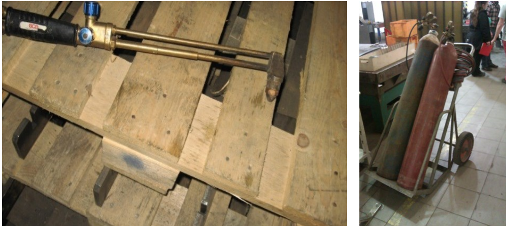
Obrázok 3 Rezací nastavec RN-7 s kolieskom pre rezanie plynom – súprava na rezanie acetylénom (Zdroj: vlastná dokumentácia)
