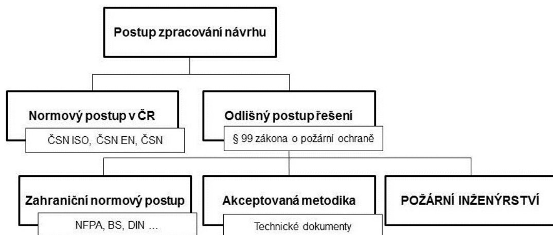
Obrázek 1 Vztah mezi normovým postupem, odlišným postupem a požárním inženýrstvím [2]
