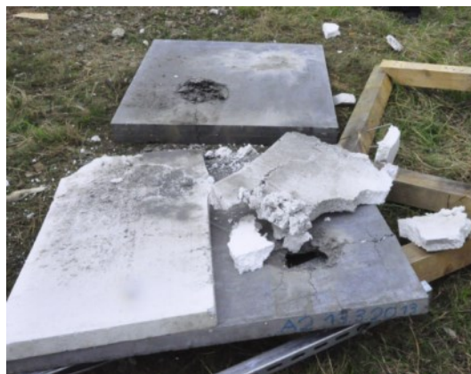
Obrázek 6 Sendvičová deska – výsledné poškození desky při kontaktním výbuchu 250g PINp 10
